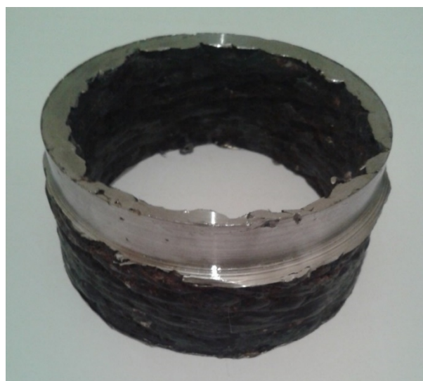
شکل 7- نمونه فلزی ساخته شده به روش ساخت افزایشی قوس و سیم بر پایه جوشکاری قوس الکتریکی با گاز محافظ.
