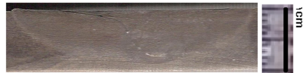
شکل ۲- مقطع عرضی اتصال FSW شده ورق فولاد A517.
