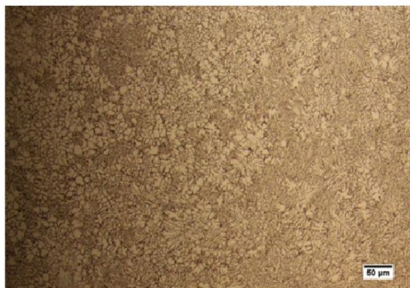
شکل 7- الف- ریزساختار فلز جوش نمونه فوق ریزدانه (N-95). شکل 7- ب- ریزساختار منطقه متأثر از حرارت نمونه فوق ریزدانه (N-95).
