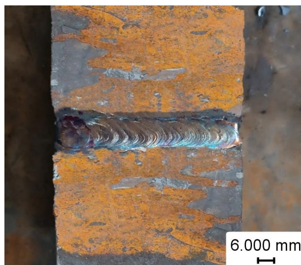
شکل 11- نمای جوش ایجاد شده در ناحیه اتصال قطعات مورد مطالعه.
