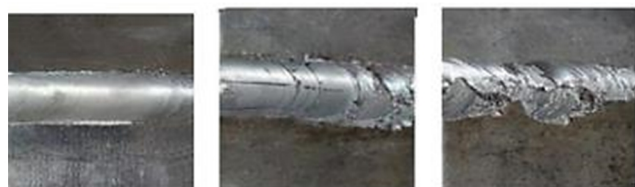
شکل 4- نمونه های FSW شده با سرعت های دورانی و خطی الف - 1600 rpm، 20 mm/min و ب - 2000rpm، 20 mm/min و ج - 12 mm/min، 1600 rpm
