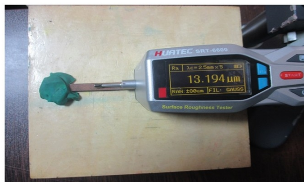
شکل 7- نمایی از دستگاه اندازه گیری صافی سطح.
