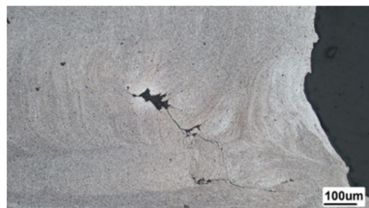
شکل 24- حفره‌های قابل مشاهده در نمونه 2 میلیمتری.
