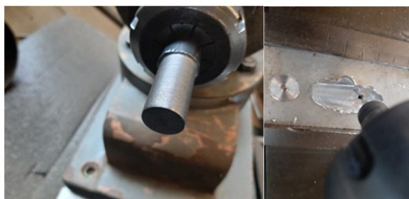
شکل 2- ابزار بدون پین جهت حذف حفره در انتهای جوشکاری.
