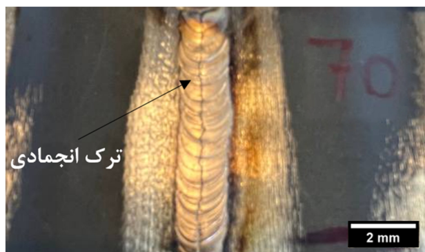
شکل 2- ترک انجمادی در نمونه با جریان 70 آمپر.
