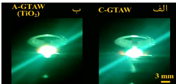
شکل 6- مقایسه قوس الف - نمونه C-GTAW. ب - نمونه A-GTAW با غلظت 1 گرم بر میلی لیتر.
