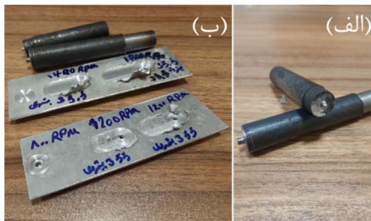
شکل 3- الف- ابزارهای مورد استفاده، ب- نمونه‌های اولیه تولید شده برای بهینه‌سازی پارامترها.
