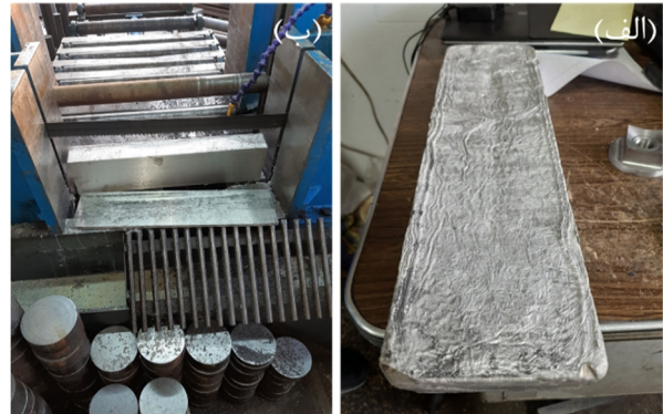
شکل 1- الف- شمش منیزیم خریداری شده و ب- برش شمش به صورت ورق به وسیله اره لنگ.
