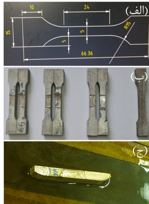
شکل 6- الف - شماتیک نمونه تست کشش، ب - تصویر نمونه‌های تست کشش و ج - نمونه متالوگرافی.
