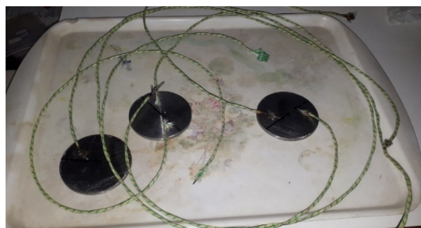
شکل 4- اتصال ترموکوپل ها به نمونه های دیسکی برای اندازه گیری نمودار دما-زمان.
