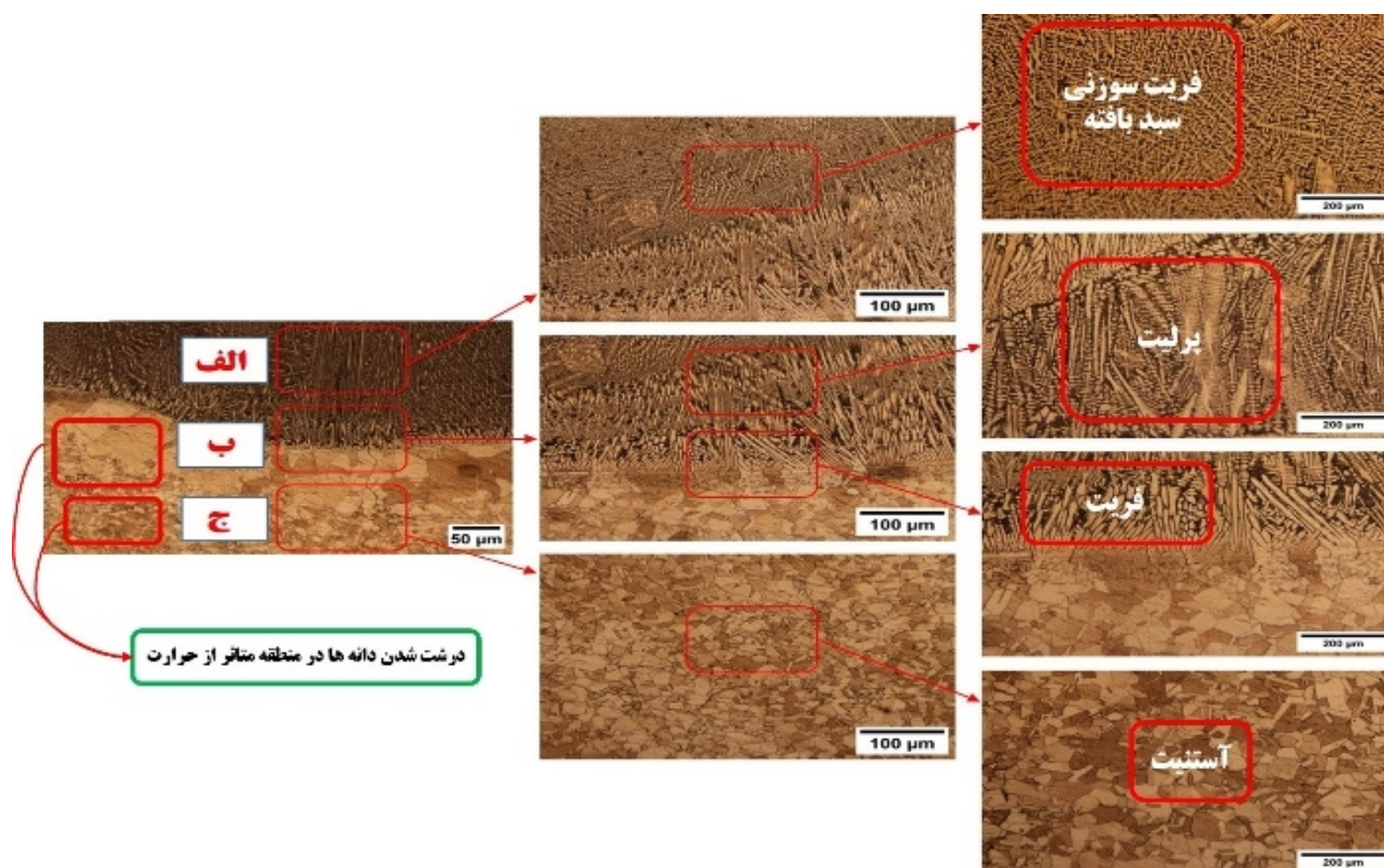
شکل 1- ریزساختار فلزپایه و فلزجوش با بزرگنمایی‌های متفاوت الف- فلزجوش، ب- فصل مشترک فلزپایه و فلزجوش، ج- فلزپایه
