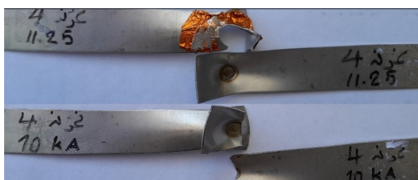
شکل 7- شکست محیطی در نمونه‌های بهینه: تصویر بالا مربوط به نمونه با لایه واسط، تصویر پایین مربوط به نمونه بدون لایه واسط.
