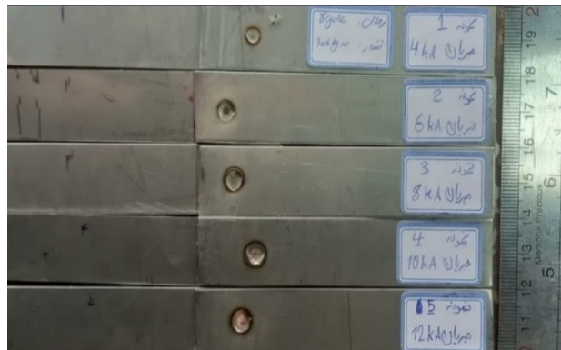
شکل 3- نمونه‌های جوشکاری شده بدون لایه واسط.
