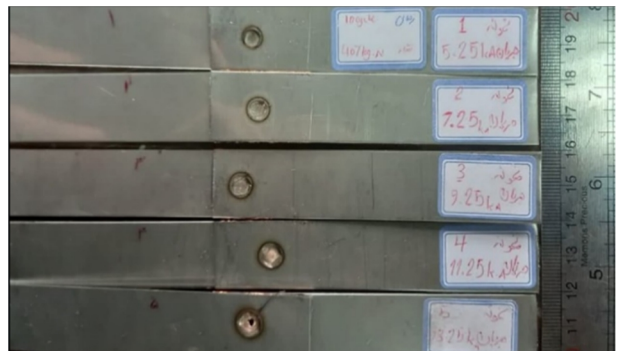
شکل 2- نمونه‌های جوشکاری شده با لایه واسط.
