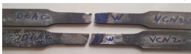
شکل 8- نمونه کشش شکسته شده در حرارت ورودی 1/73 KJ/mm
