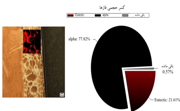
شکل 7- کسر حجمی فاز یوتکتیک و فاز اولیه \alpha اتصال با فلز پرکننده \text{Ag-Cu-Ti-Sn-3.5Zr} با استفاده از نرم افزار Mip.
