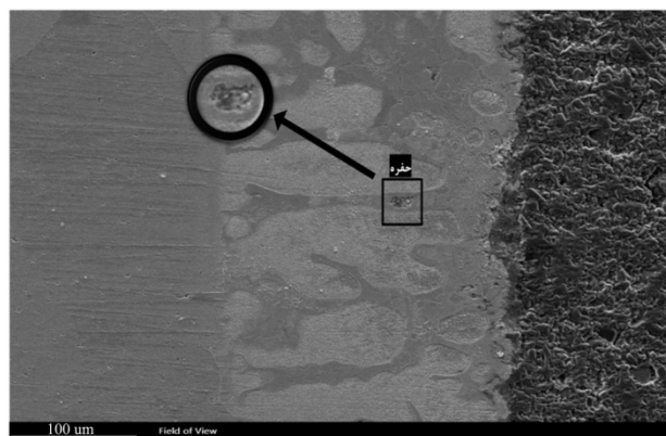
شکل 11- تصویر میکروسکوپی الکترونی روبشی از اتصال \text{Al}_2\text{O}_3/\text{Cu} با فلز پرکننده Ag-Cu-Ti-Sn.
