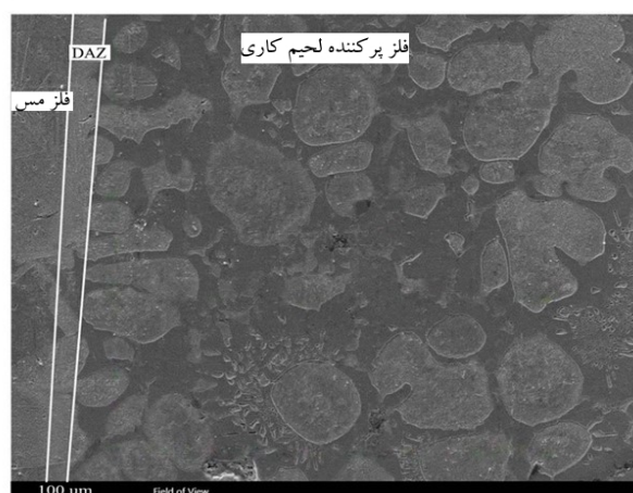
شکل 15- تصویر میکروسکوپی الکترونی روبشی از اتصال Al_2O_3/Cu با فلز پرکننده Ag-Cu-Ti-Sn-3.5Zr
