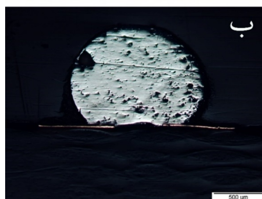
شکل 6- تصاویر میکروسکپ نوری از ریزساختار آلیاژ لحیم غیر کامپوزیتی بعد از گذشت الف - 0 و ب - 1135 ساعت از زمان آزمون مهاجرت الکترونی.
