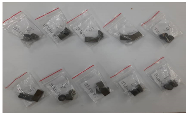
شکل 2- تصویر نمونه‌های جوشکاری شده بعد از وایرکات.
