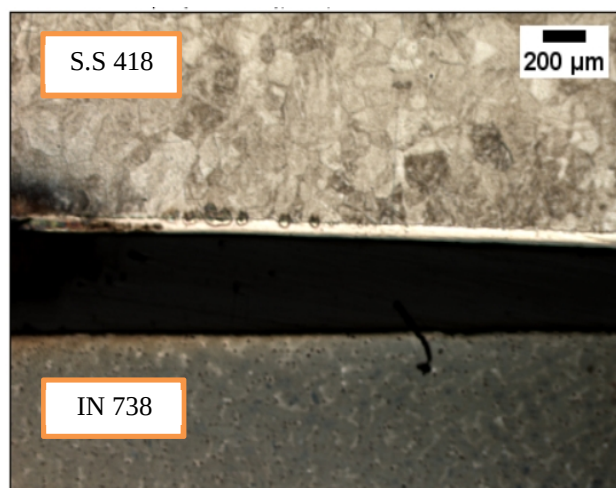
شکل 15- تصویر میکروسکوپ نوری نمونه S8 در بزرگمایی 5X.
