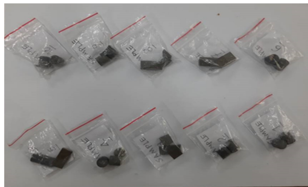
شکل 2- تصویر نمونه‌های جوشکاری شده بعد از وایرکات.
