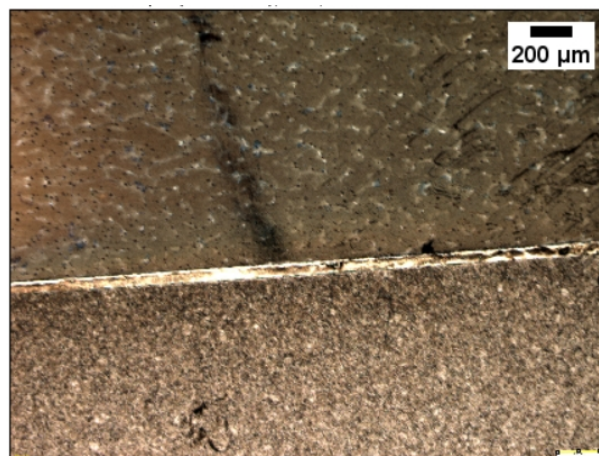
شکل 12- تصویر میکروسکوپ نوری نمونه S7 در بزرگنمایی 5X.
