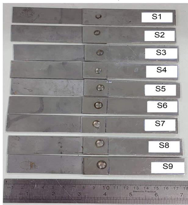
شکل 1- تصویری از نمونه‌های جوشکاری شده بوسیله دستگاه جوشکاری نقطه‌ای مقاومتی.
