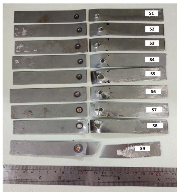
شکل 17- تصویر شکست نمونه‌ها پس از آزمون کشش برشی.
