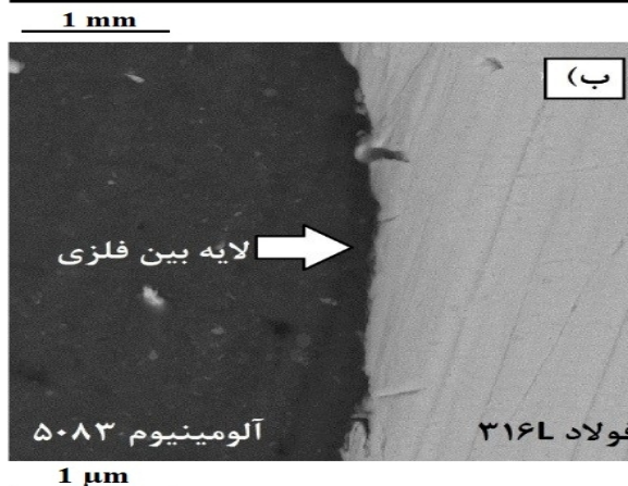
شکل 11- تصویر میکروسکوپی الکترونی روبشی الف - منطقه اغتشاشی نمونه جوشکاری شده با سرعت چرخش 250 دور در دقیقه و سرعت پیشروی 25 میلی متر بر دقیقه و ب - منطقه مشخص شده با دایره قرمز در شکل الف با بزرگنمایی بیشتر.
