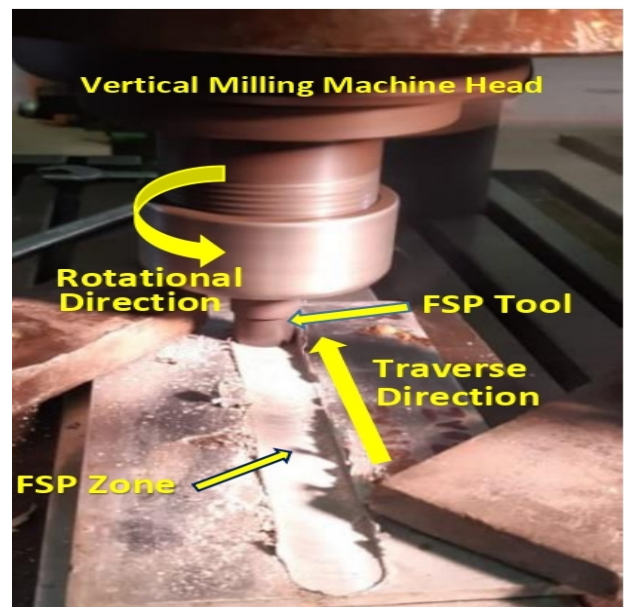
شکل 1- طرح عملیات فرایند اصطکاکی اغتشاشی یکی از نمونه‌ها.
