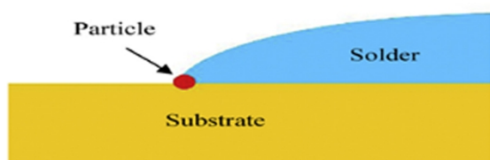
شکل 5- شماتیک محل قرارگرفتن نانو ذرات حین لحیم‌کاری [5].
