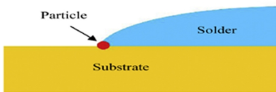
شکل 5- شماتیک محل قرارگرفتن نانو ذرات حین لحیم‌کاری [5].
