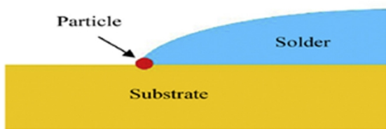
شکل 5- شماتیک محل قرارگرفتن نانو ذرات حین لحیم‌کاری [5].
