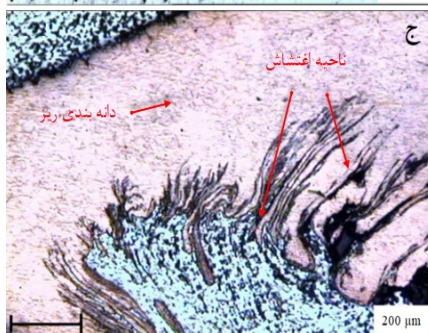
شکل 3- تصاویر متالوگرافی نوری در ناحیه اغتشاش آلومینیوم - مس الف- نمونه شماره 1، ب- نمونه شماره 2، ج- نمونه شماره 3.
