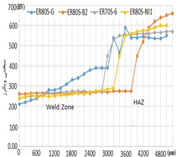
شکل 4- سختی ویکرز برحسب فاصله از مرکز جوش برای نمونه های جوشکاری شده با فلزهای پرکننده مختلف.
