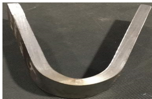
شکل 11- نمونه بعد از اتمام آزمایش خمش.
