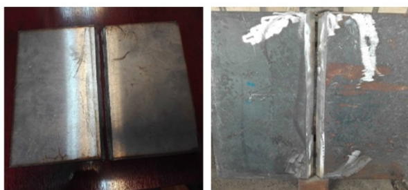
شکل 1- نمونه‌های برشکاری شده از آلیاژهای SA516-GR60 و
