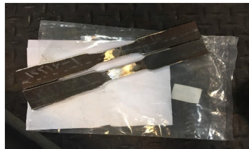
شکل 4- نمونه قطعه آماده شده برای آزمایش کشش.
