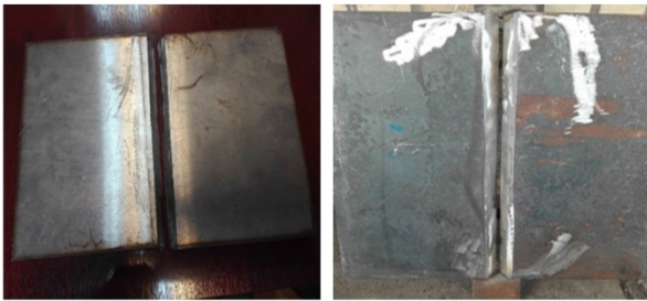
شکل 1- نمونه‌های برشکاری شده از آلیاژهای SA516-GR60 و SA240-TP316 برای تهیه PQR.
