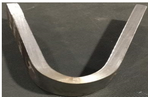
شکل 11- نمونه بعد از اتمام آزمایش خمش.
