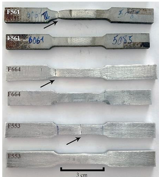
شکل 6- تصاویر نمونه‌های آزمون کشش قبل و بعد از اجرای آزمون.
