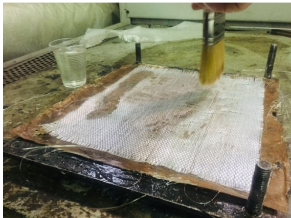
شکل 1- ساخت نمونه‌های پلیمری گرماسخت تقویت شده با الیاف شیشه.
