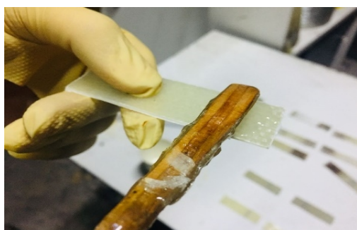
شکل 4- چسب‌کاری قطعه سطح صاف
