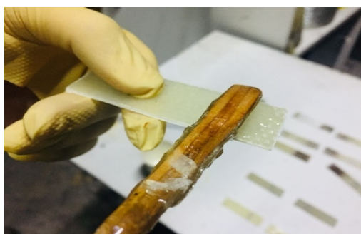
شکل 4- چسب‌کاری قطعه سطح صاف
