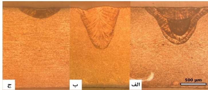
شکل 5- تصاویر متالوگرافی نمونه‌های به ترتیب با الف- R_a = 0,05 ب- R_a = 0,16 و ج- R_a = 0,57 میکرومتر با بزرگنمایی پنج برابر.
