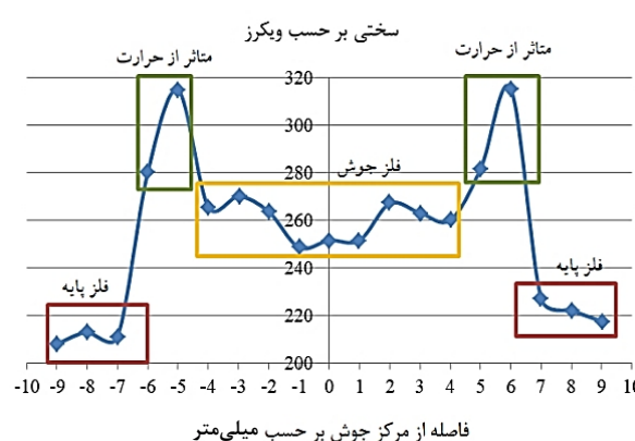
شکل 7- پروفیل سختی جوش و نواحی اطراف آن.
