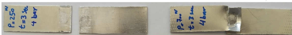
شکل 7- نمونه‌ای از جدا شدن ورق‌ها.
