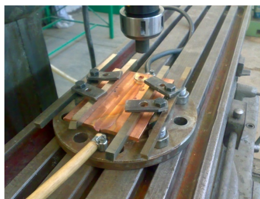
شکل 1- قالب جوشکاری مجهز به سیستم خنک کننده.
