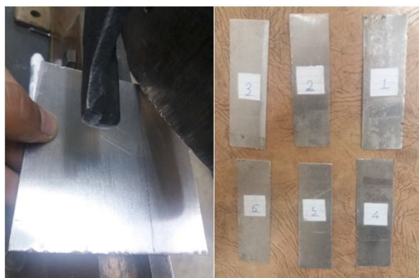
شکل 2- آماده سازی و برش کاری نمونه های شاهد
