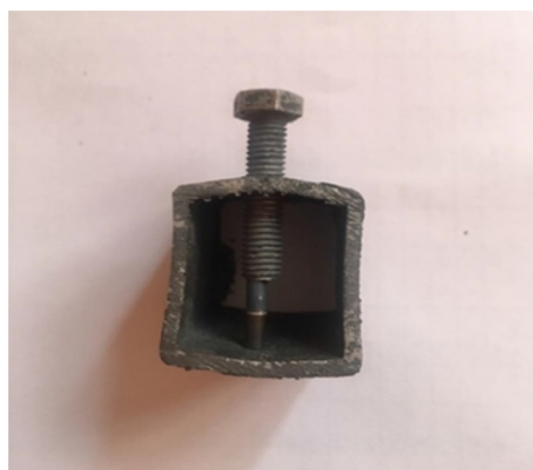
شکل 2- نحوه قرارگیری نمونه‌ها در فیکسچر
