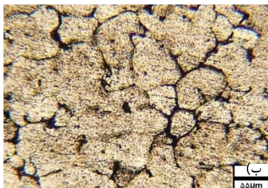
شکل 2- ساختار فلز پایه آلیاژ آلومینیوم ریختگی عملیات حرارتی شده در بزرگنمایی‌های مختلف: (الف) 50x، (ب) 200x.
