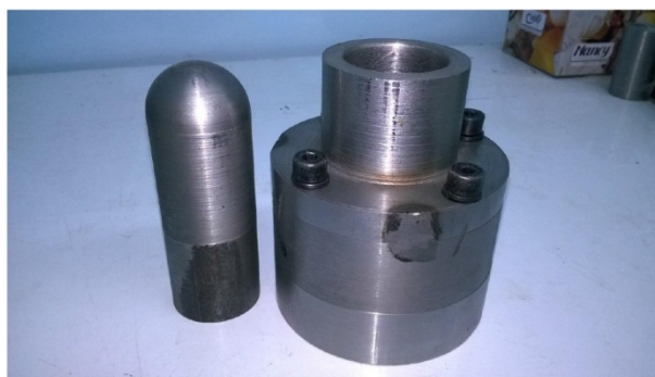
شکل 2- قالب آزمون ارتفاع گنبد مورد استفاده در این تحقیق
