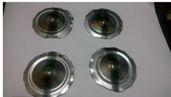
شکل 3- نمونه هایی از ورق های ترکیبی شکل دهی شده در قالب آزمون ارتفاع گنبد و پارگی های ایجاد شده بر روی آنها
