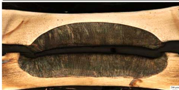
شکل 14- مطابقت یک نمونه جوش نامشابه TWIP/HSLA شکسته شده در آزمون کشش متقاطع با شکل دکمه جوش متناظر جهت پیدا کردن مسیر رشد ترک.
