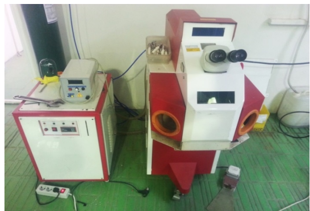
شکل 2- دستگاه جوش لیزر پالسی
