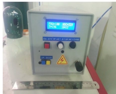
شکل 4- بخش کنترلی قید و بند جابجایی نمونه زیر پرتو لیزر
