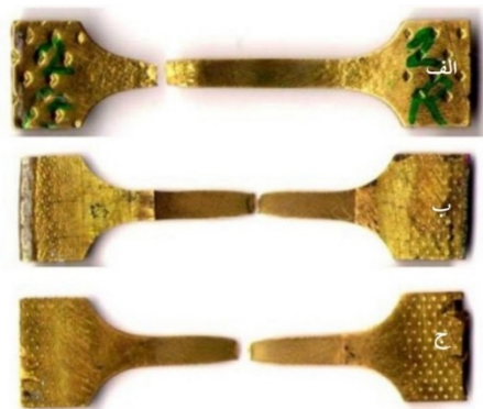
شکل 8- تصاویر ماکرو از نمونه‌های کشش پس از جوشکاری با سرعت چرخشی 400 rpm و سرعت پیشروی 100 mm/min: (الف) نمونه آنیل شده، (ب) نمونه یک مرحله نورد تجمعی و (ج) نمونه سه مرحله نورد تجمعی.
