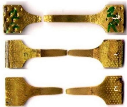
شکل 8- تصاویر ماکرو از نمونه‌های کشش پس از جوشکاری با سرعت چرخشی 400 rpm و سرعت پیشروی 100 mm/min: الف) نمونه آنیل شده، ب) نمونه یک مرحله نورد جمعی و ج) نمونه سه مرحله نورد جمعی.
