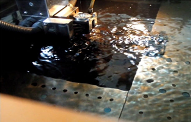
شکل 1- برشکاری با استفاده از دستگاه واترجت
