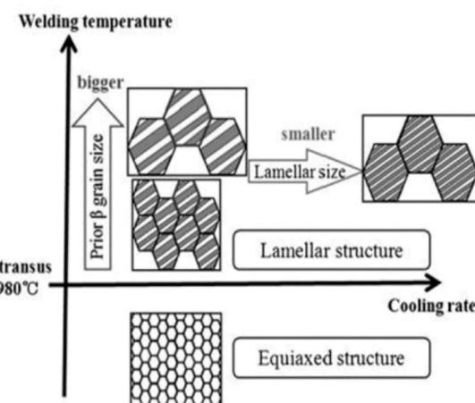
شکل 5- تأثیر شرایط جوشکاری اصطکاکی همزنی بر روی آلیاژ Ti-6Al-4V [18].
