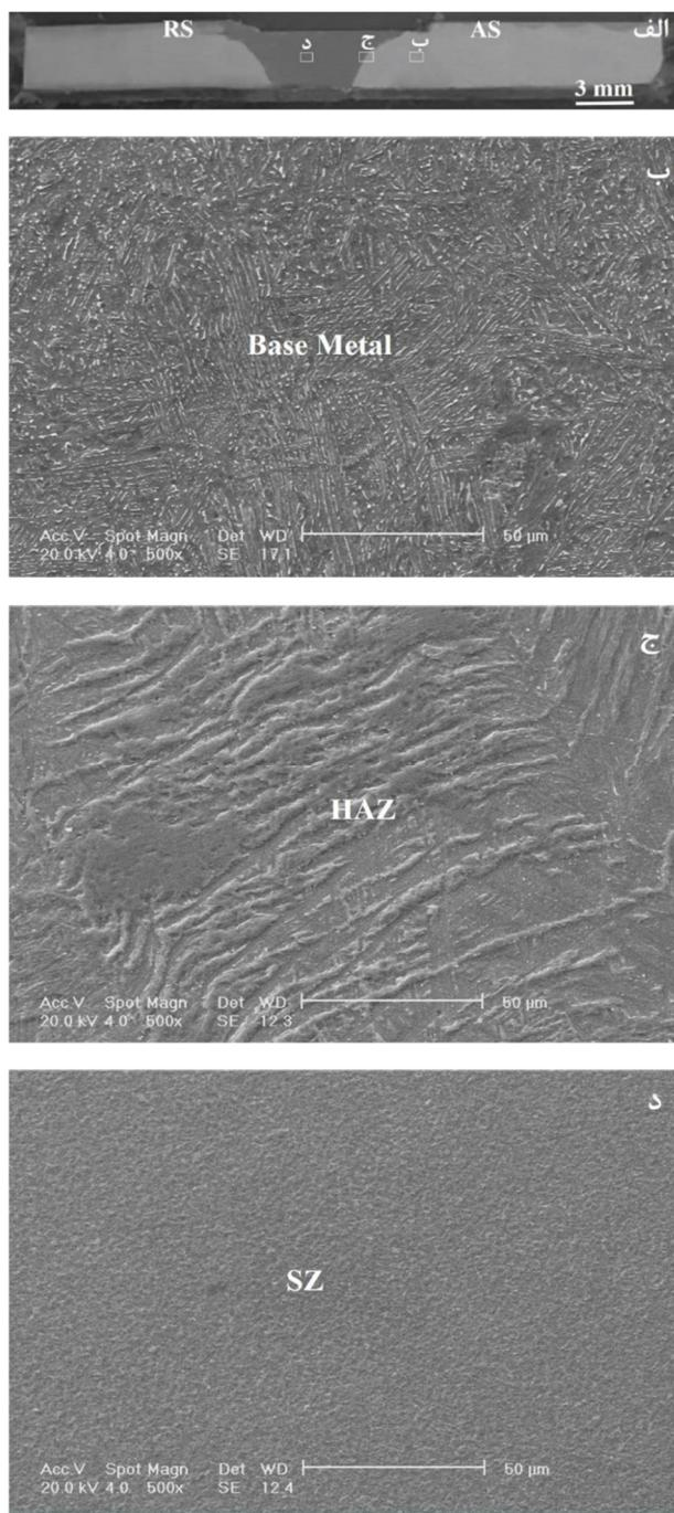
شکل 4- تصاویر میکروسکوپی ناحیه اتصال و جوش نمونه Ti-6Al-4V (الف) مقطع عرضی اتصال، (ب) فلز پایه، (ج) ناحیه تحت تاثیر حرارت، (د) ناحیه همزنی
