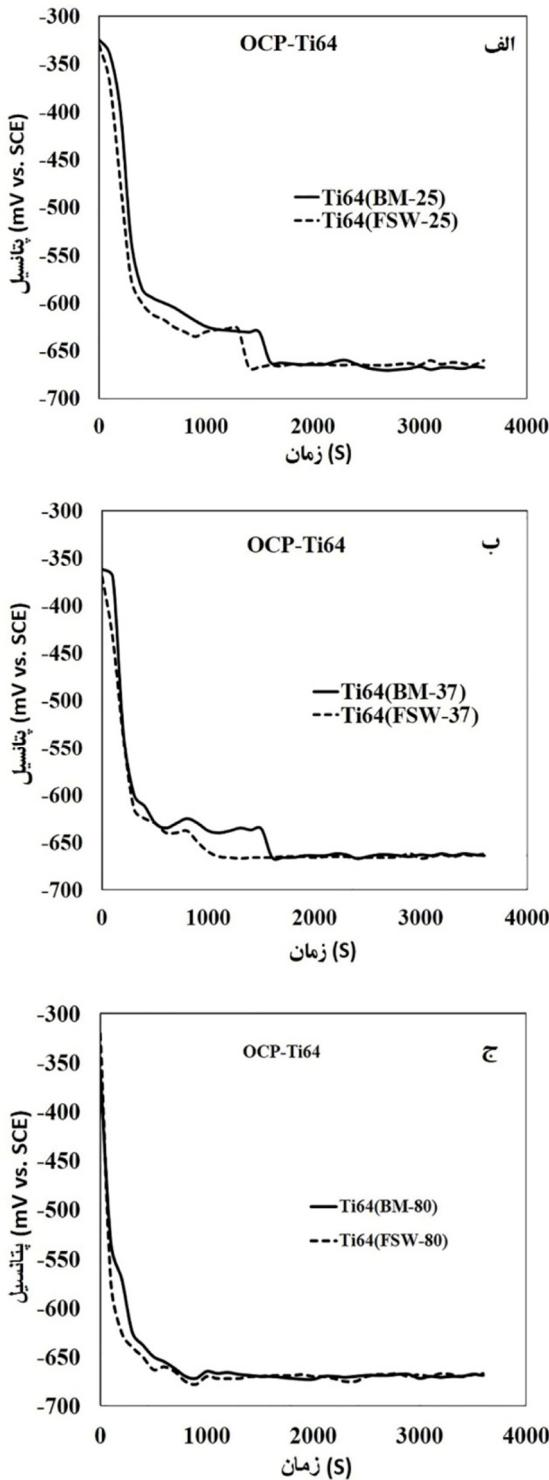
شکل 8- تغییرات پتانسیل مدار باز آلیاز  $Ti-6Al-4V$  در درصد 3/5  $NaCl$  (الف) 25، (ب) 37، (ج) 80 درجه سانتی گراد.
