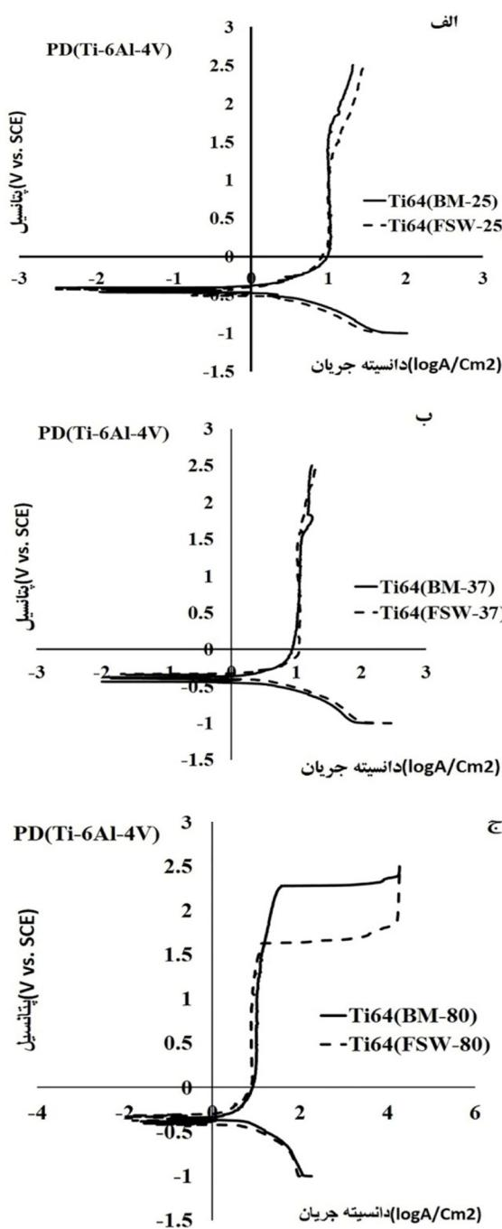
شکل ۹- منحنی‌های پتانسیودینامیک  $Ti-6Al-4V$  در شرایط جوشکاری اصطکاکی همزنی در محلول  $3/5\text{NaCl}$  در دماهای (الف) ۲۵، (ب) ۳۷، (ج) ۸۰ درجه سانتی‌گراد.
