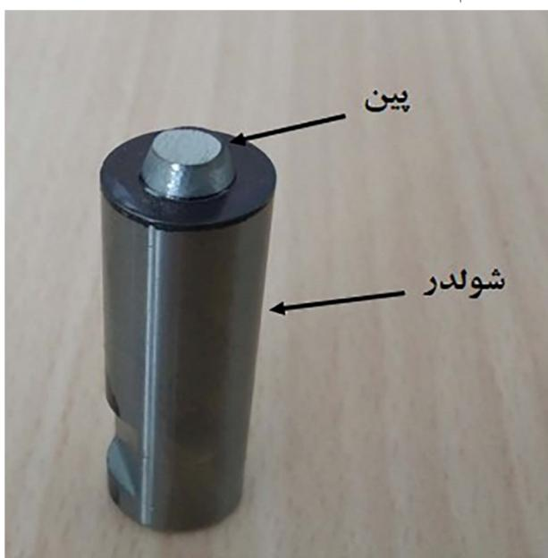
شکل 1- تصویر پین و شولدر جوشکاری اصطکاکی همزنی.
